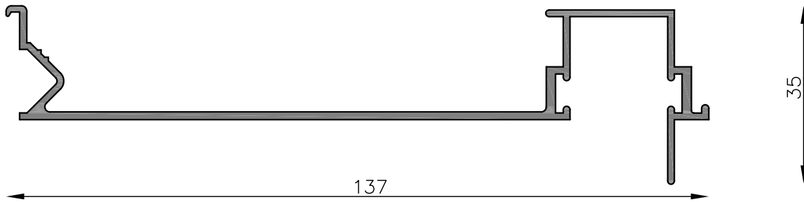
MT-0244 Guía de cortina barrio Peso estimado: 0.896 Kg/m Largo STD: 6150 mm
